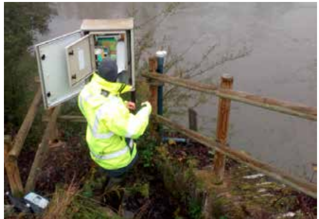
Un agent vérifiant les appareils de mesure d'une station hydrométrique
